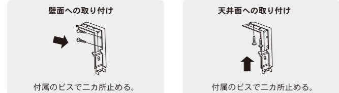
B本体端間隔が均等になるよう調整し、Aプラケット間隔を広めに確保してください。取り付け位置によって、補強や取り付けバランス確保のため、本体加重を分散させる必要がある場合には、別売の「追加プラケット」をご利用下さい。
